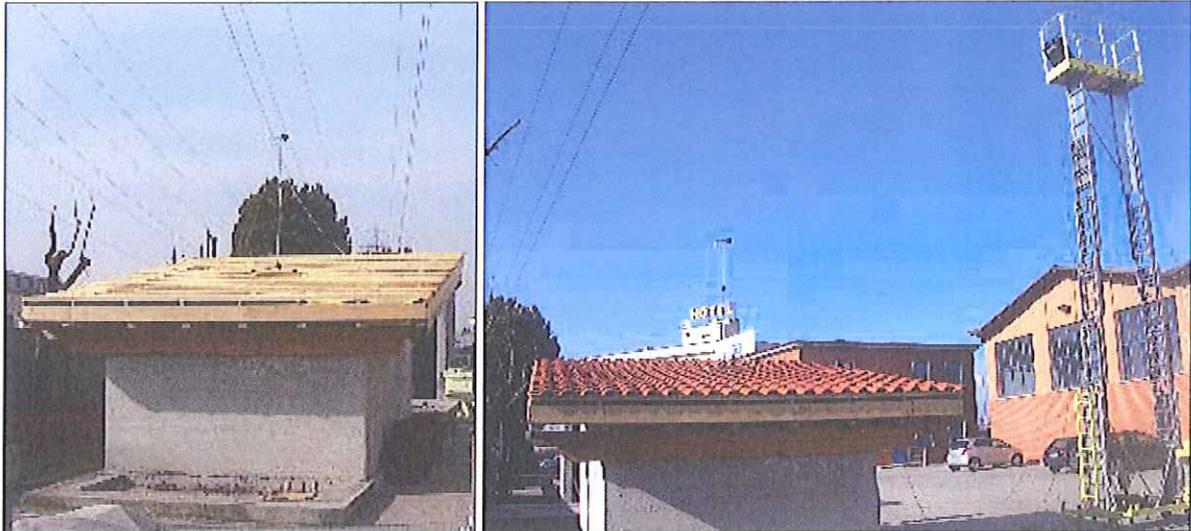
Figura 2 – Cella di prova per falde tetto: disposizione della cassa all'esterno nelle due configurazioni di prova con e senza tegole.
