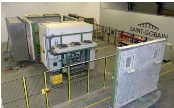
Immagini dell'impianto per l'invecchiamento delle pareti di prova
