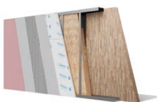
SOL. 107 Controparete esterna Gyproc 119/100 LA34 GX Parete X-LAM sp. 100 mm Guide e montanti Gyproc External Profile Zn-Mg da 100 mm + lana minerale Isover Arena34 sp. 95 mm 1 lastra Gyproc Glasroc® X 13 (tipo GM-H1FI, peso 12 kg/m²) sp. 12,5 mm con ciclo di finitura
