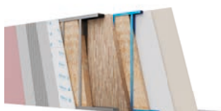
SOL. 110 Controparete esterna Gyproc 119/100 LA34 GX + controparete interna CP.S 75/50 LA34 DG STD 1 lastra Gyproc DuraGyp 13 Activ'Air® (tipo DEFH1IR, peso 12,3 kg/m²) sp. 12,5 mm 1 lastra Gyproc Wallboard 13 (tipo A, peso 9,2 kg/m²) sp. 12,5 mm Guide e montanti Gyproc Gyprofile da 50 mm + lana minerale Isover Arena34 sp. 45 mm Parete X-LAM sp. 100 mm Guide e montanti Gyproc External Profile Zn-Mg da 100 mm + lana minerale Isover Arena34 sp. 95 mm 1 lastra Gyproc Glasroc® X 13 (tipo GM-H1FI, peso 12 kg/m²) sp. 12,5 mm con ciclo di finitura
