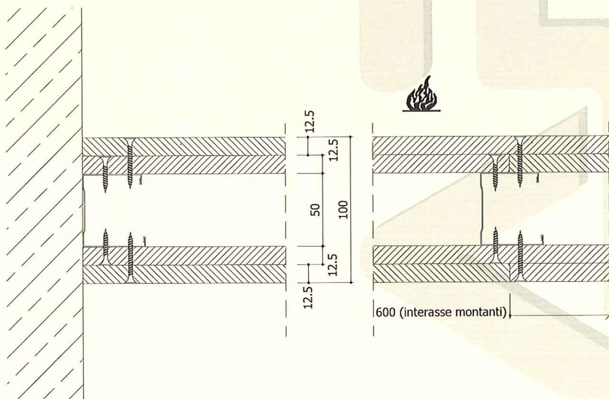
Sezione orizzontale campione in prova
