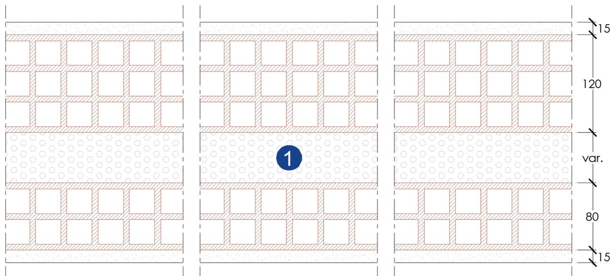
Intervento di isolamento mediante insufflaggio in intercapedine di lana di vetro in fiocchi, per il miglioramento dell'efficienza energetica ed il comfort termico ed acustico degli edifici esistenti, realizzato con:
