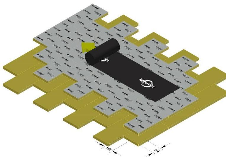
I pannelli termoisolanti, se di forma rettangolare, possono essere anche posati a “spina di pesce” e, di conseguenza, l’elemento di tenuta potrà essere posizionato sia trasversalmente che parallelamente alla direzione di pendenza.
