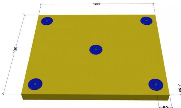
Per pannelli o parti di pannello con superficie  $> 1,00 \text{ m}^2$  e  $\leq 1,80 \text{ m}^2$ : 5 fissaggi/pannello o parti separate di pannello
