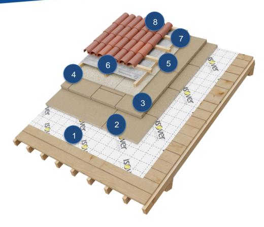
Copertura a falda in legno isolata, costituita dagli elementi sottoelencati (dall'interno all'esterno):
