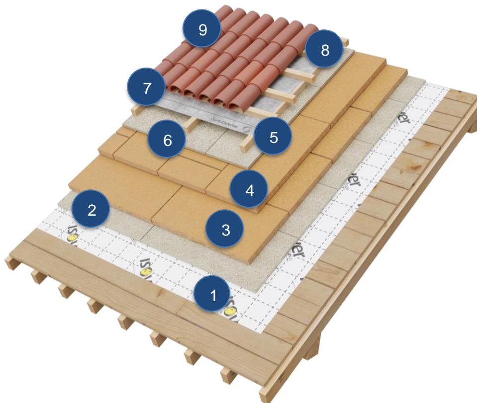
Copertura a falda in legno isolata con membrana costituita dagli elementi sottoelencati (dall'interno all'esterno):
