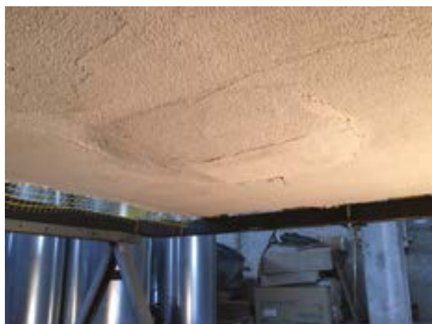
Test con intonaco, rete e tasselli
