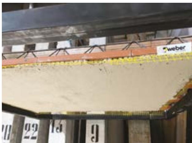
Test con intonaco, rete e tasselli
