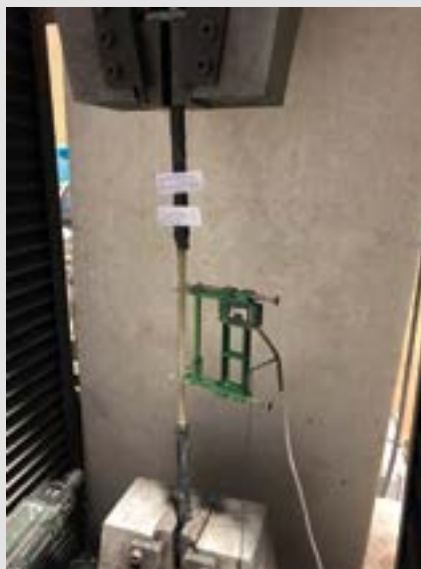
Prova di trazione diretta sul connettore
