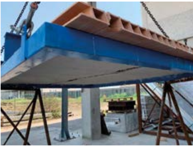
Fase test, intradosso solaio sistema integrale
