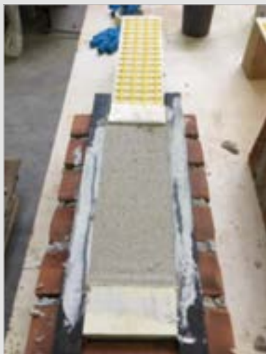
Confezionamento provini per prove di distacco dal supporto
