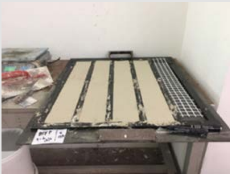
Confezionamento provini per prove di trazione diretta
