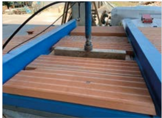
Simulacro solaio e strumentazione di prova
