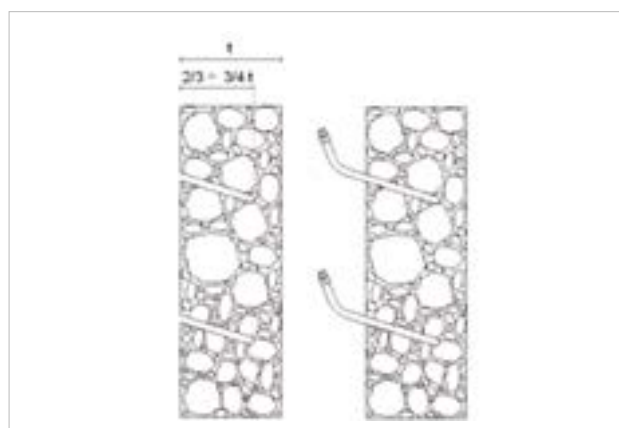
Schema per profondità delle iniezioni
