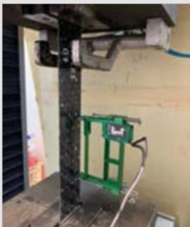
Prova di trazione diretta su laminato FRP
