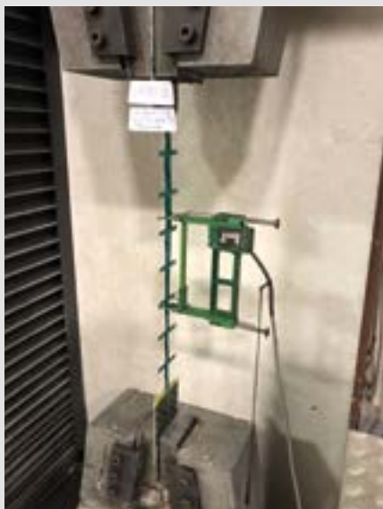
Prova di trazione diretta dei fili della rete
