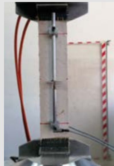
Prova di trazione diretta su composito FRCM
