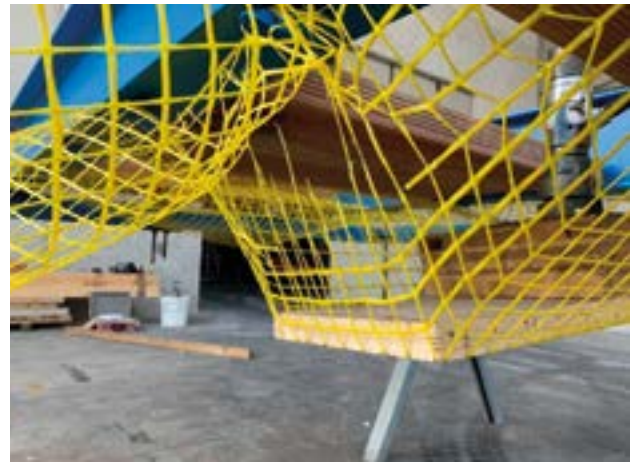
Collasso del sistema con sola rete
