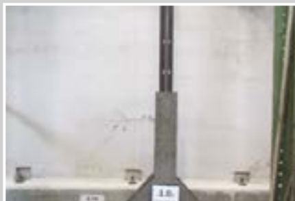
Campione rinforzato, danneggiamento al 1% drift
