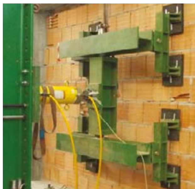
Particolare del sistema per l'applicazione del carico
