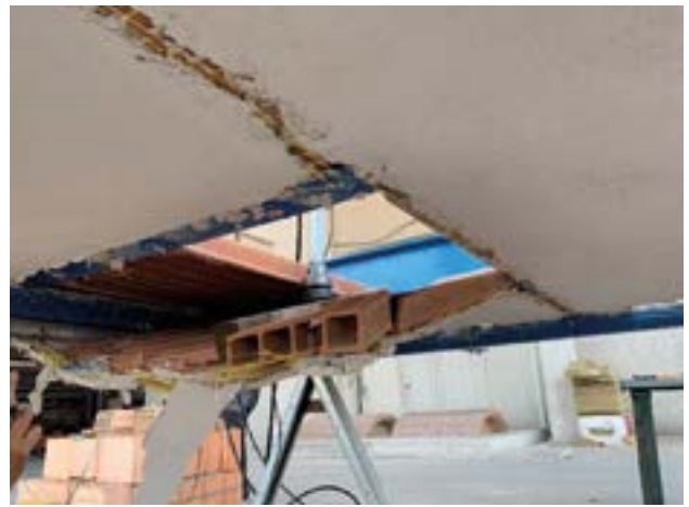
Collasso sistema integrale
