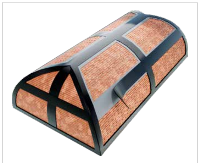
Rinforzo in carbonio con sistema webertec CFRP
