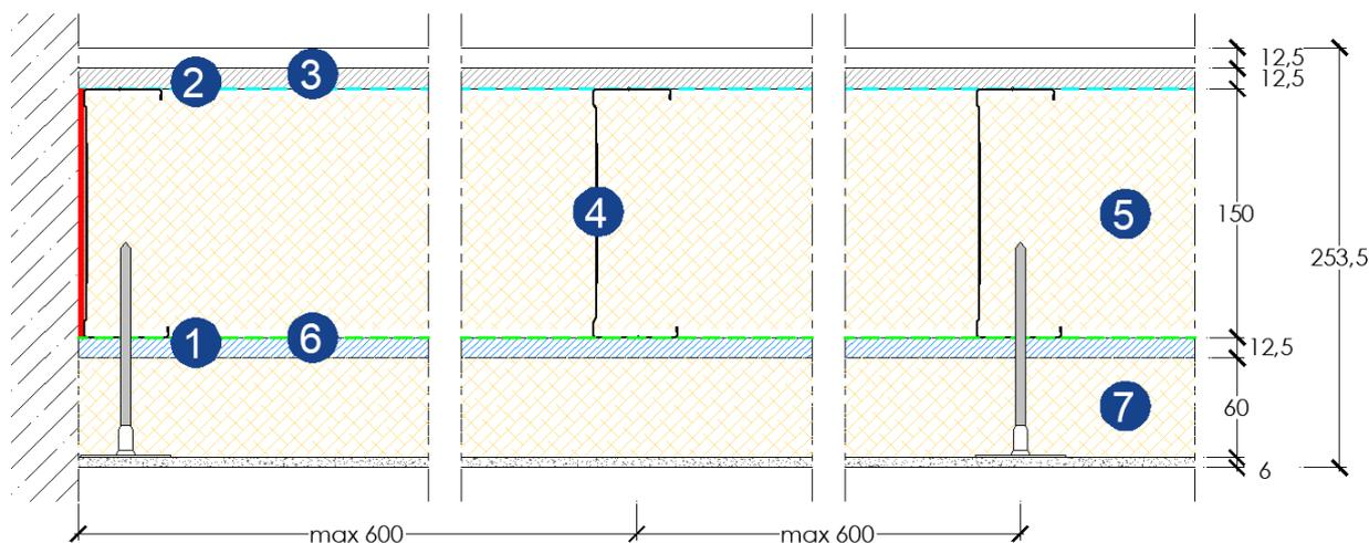
Parete di tamponamento esterno Gyproc SA3 254/150 L GX HF CLIMA dello spessore totale di 253,5 mm circa costituita dagli elementi sottoelencati:
