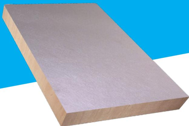
Pannello isolante costituito da una schiuma fenolica a cellule chiuse, espansa senza l'impiego di CFC e HCFC, rivestito su entrambe le facce da uno strato di velo vetro saturato.
