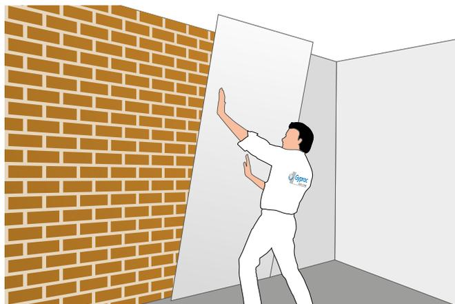
Assicurarsi che il manufatto sia a piombo rispetto al tracciamento battendo leggermente la lastra e verificandone la verticalità. Procedere con lo stesso metodo per le lastre successive e, per ottenere l'allineamento, batterle leggermente a due a due.
