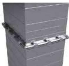
Le sezioni del canale devono essere connesse tramite flange d'acciaio di minimo 30 x 30 mm dallo spessore di 0,8 mm (1mm per condotte estrazione fumi EI120), fissate al canale utilizzando la saldatura a punti o viti di acciaio distanziate di 150 mm.
