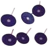
L'isolamento è fissato alla condotta tramite **arpioni** pre-saldati di diametro minimo 2,7 mm, e rondelle di acciaio a molla di minimo 30 mm di diametro. Si consiglia di scegliere arpioni leggermente più lunghi dello spessore dell'isolamento (-3 mm più lunghi).
