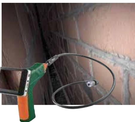
Ispezionare l'intercapedine da isolare per verificare lo stato del paramento esterno e del paramento interno. L'insufflaggio non è adatto in caso di intonaco danneggiato (es. crepe) o di significativa presenza di infiltrazioni d'acqua o umidità di risalita.
