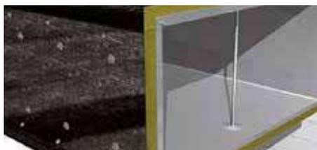
Ogni segmento della condotta possiede un elemento di rinforzo interno, posizionato esattamente a metà del segmento. Nel caso di condotte estrazione fumi EI120 in cui almeno un lato della sezione superiori i 500mm, sono necessari 5 rinforzi distribuiti lungo il tratto di condotta.
