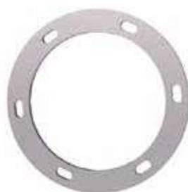
Per condotte estrazione fumi aggiungere, tra le barre di supporto, una flangia piatta di 40 x 5 mm (ogni 1200 mm). La stessa cosa vale per proteggere una condotta di ventilazione per 120 min.
